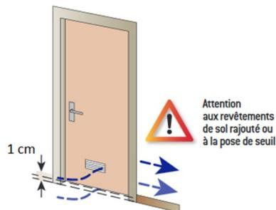
Figure 3 : Schéma détalonnage porte intérieure
